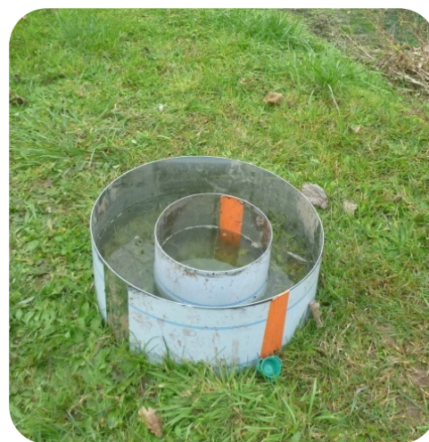
Test de perméabilité double anneaux
