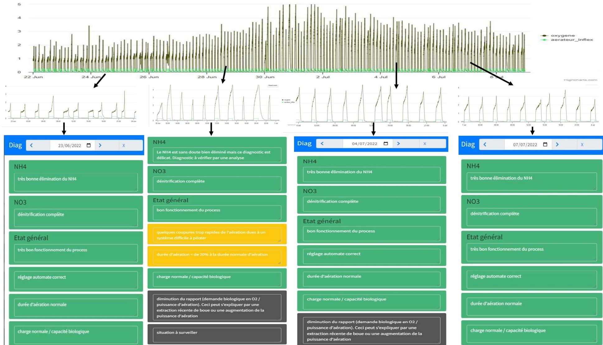
**Figure 21** - séquence d'une purge de boue massive entraînant une situation temporaire de sur-aération. Station de St LARY
